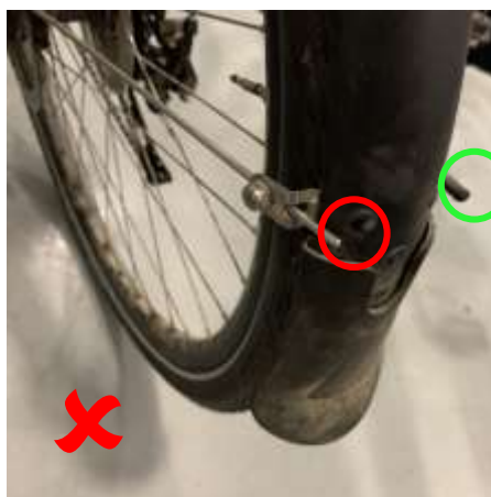
Protections en bout de tige manquantes
