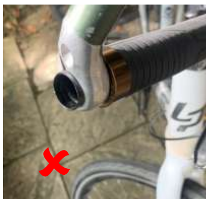
Pas d'embout de guidon
