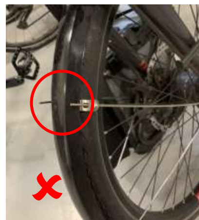
Protections en bout de tige manquantes et tiges un peu longues
