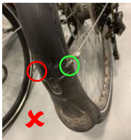
Protections en bout de tige manquantes
