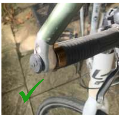
Bouchon en bout de guidon Un bouchon en liège peut faire l'affaire
