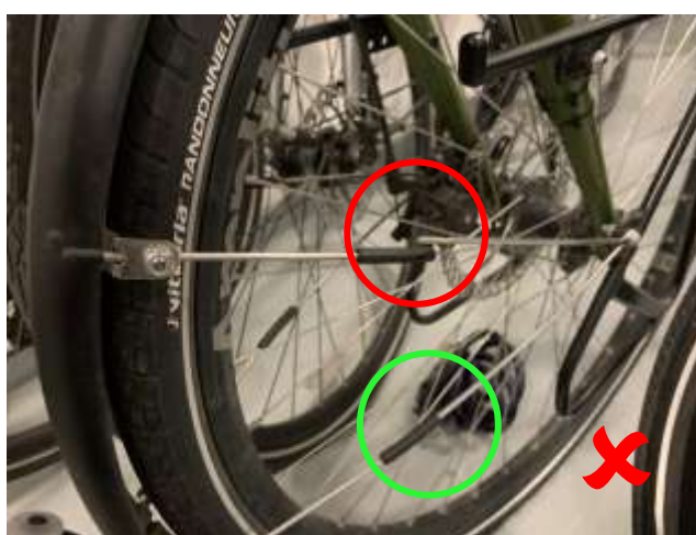
Tringles déboîtées. Penser à la remettre correctement En cas de chute, risque de perforation au niveau des jambes
