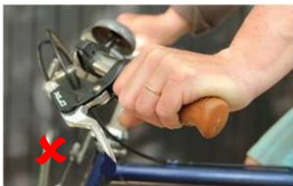
Bout de poignée de freins cassé avec une partie pointue
